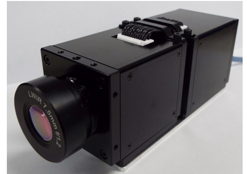
カメラ外観 （写真はf=7.5mm F/1.2レンズ装着時）
